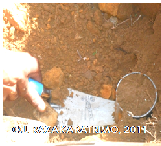
Photo 4: Extraction du cylindre
