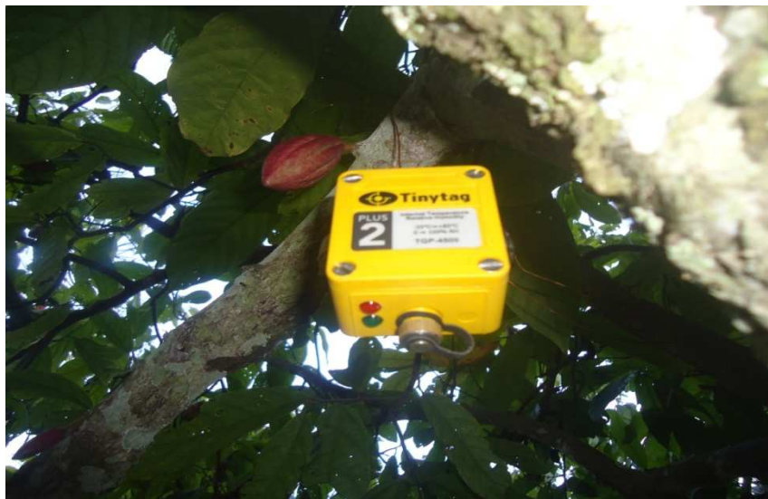
Figure 12: Capteur mesurant les températures et l'humidité relative placé sur une branche de cacaoyer.
