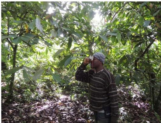
**Figure 6: Mesure à 15 m de la hauteur d'un arbre à l'aide d'un clinomètre SUUNTO**
